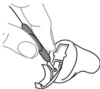
Otvorite vratanca za bateriju i okrenite slušni aparat tako da poklopac bude okrenut nadole (pogledajte sliku). Vodite kratak alat za uklanjanje voska (br. 4) kroz otvore mikrofona na vratancima iz unutrašnjosti (pogledajte crtež).
